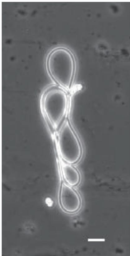
強い磁場下では、リン脂質からなるベシクルチューブは、磁場に平行に配向する。チューブと拮抗する磁場配向性を持つコラーゲンを封入すると、磁場の効果が抑えられ、チューブの曲げの効果が顕在化し、“エラストイカ”と呼ばれる奇妙な曲線構造が産み出される。
